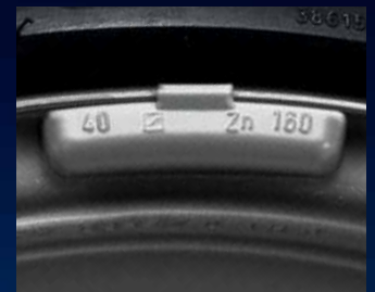
Beschichtete Gewichte: Geschlossene Epoxydoberfläche. Min. 0,1 mm dick. Ca. 5 % Aluminiumpigmente, eingebettet in Synthetikmoleküle. Dadurch keine Oxidation der Oberfläche.
