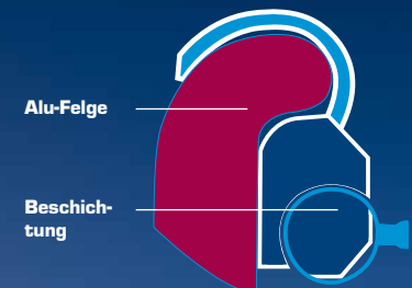
Beschichtete Gewichte: Geschlossene Epoxydoberfläche. Min. 0,1 mm dick. Ca. 5 % Aluminiumpigmente, eingebettet in Synthetikmoleküle. Dadurch keine Oxidation der Oberfläche.
