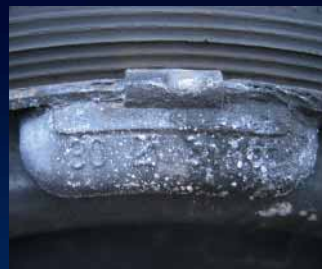
Unbeschichtete Gewichte: Kontaktkorrosion der Oberfläche.
