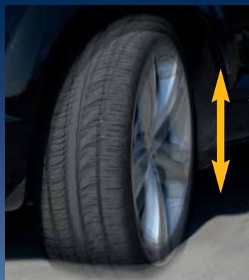
Die Statische Unwucht: Das Rad neigt zum Springen.
